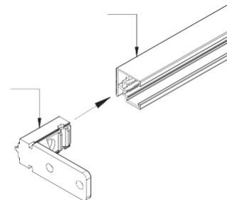
3 Фиксируем боковое крепление в профиле с помощью шурупа
